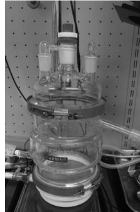
Figura 4. Digestor que imita el comportament del rumen
